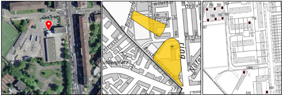
Abbildung 27: Messstelle F_1305 mit der baulichen Infrastruktur, belasteten Standorten und dem Auszug aus dem Versickerungskataster. Zwei Unterirdische Versickerungen 185, 716; drei Versickerungen mit Bodenpassage 1566, 616, 839.
